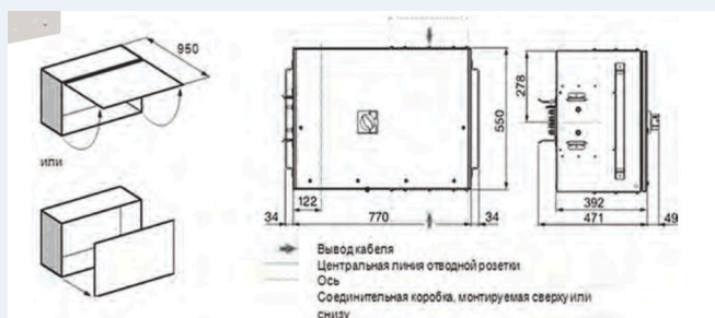
DC 630 A: корпус 770 × 550 мм, вылет 850 мм, посадочные 392 / 471 мм, масса 45 кг. Соединительная коробка монтируется сверху или снизу
